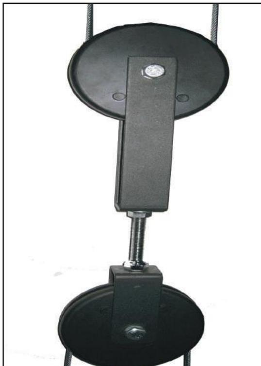
Au début, il y a un allongement naturel du câble, ce qui est un processus normal et non un défaut de qualité. Activer la mise sous tension du câble dans le sens des aiguilles avec l'écrou : la corde est étirée. Antihoraire, le câble est posé.
